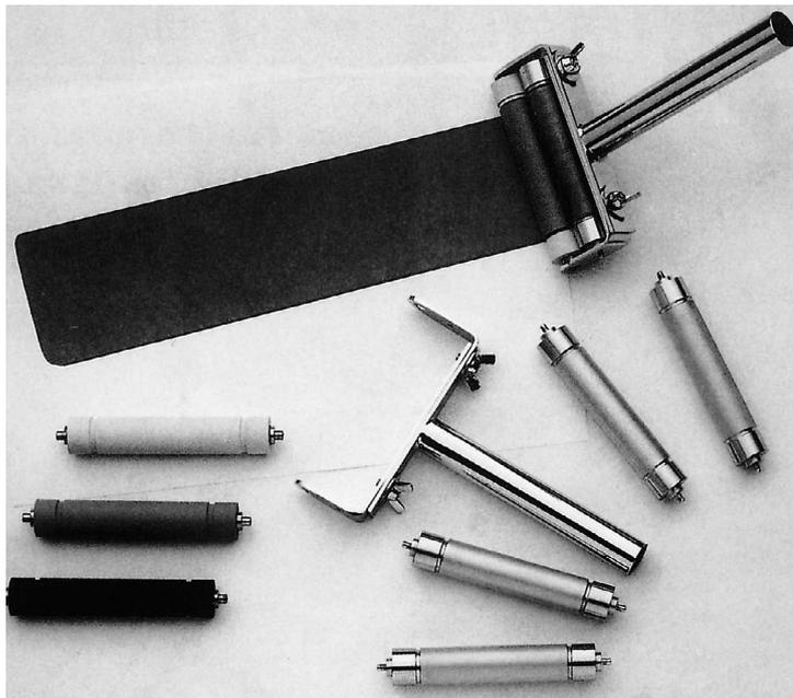
Колор-тестер имеет простую и надежную конструкцию, состоящую из анилоксового и резинового валиков, закрепленных в жесткой полированной хромированной рамке с удобной рукояткой.
