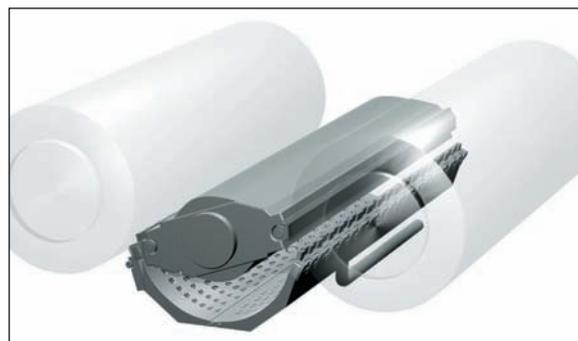
Каркасный передаточный цилиндр/
