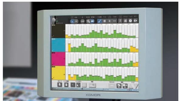
PDC-SII — автоматизированный контроль цвета на базе спектроденситометра (опция)
