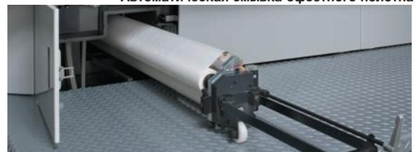
Автоматическая смывка печатного цилиндра
