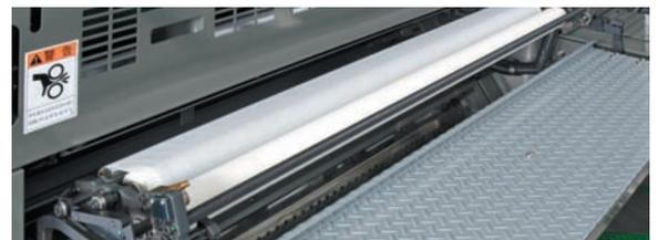
Автоматическая смывка офсетного полотна
