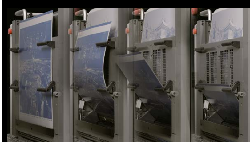
Новая система Full-APC Lithrone S26/S29 может быть оснащена системой Full-APC. Все четыре формы заменяются всего за 150 с. Новая система зажимных планок делает работу быстрой и беспроблемной.
