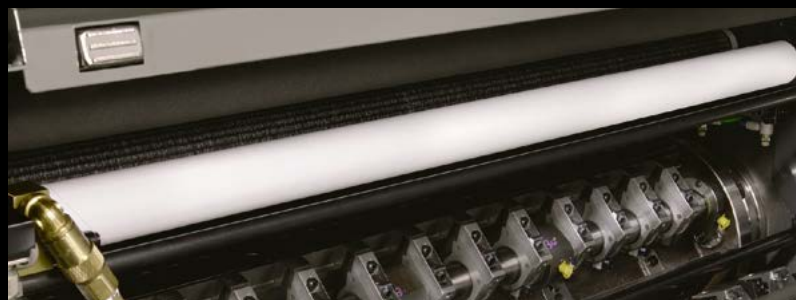
Новая зажимная планка не требует загибки задней кромки Новая система зажимных планок, используемая в Full-APC, существенно повышает эффективность загрузки и выгрузки форм. Кроме того, отсутствие необходимости загибки задней кромки формы устраняет целый этап производственного процесса. Плоская конструкция зажима позволяет системе повысить точность приводки и гарантировать очень высокое качество печати в дополнение к высокой производительности.
