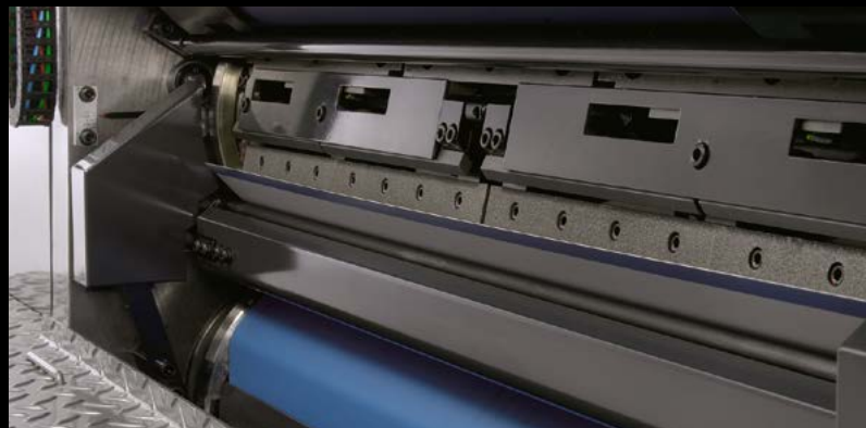
Новая зажимная планка не требует загибки задней кромки Новая система зажимных планок, используемая в Full-APC, существенно повышает эффективность загрузки и выгрузки форм. Кроме того, отсутствие необходимости загибки задней кромки формы устраняет целый этап производственного процесса. Плоская конструкция зажима позволяет системе повысить точность приводки и гарантировать очень высокое качество печати в дополнение к высокой производительности.
