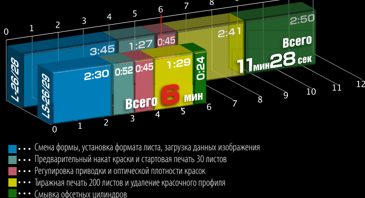
Короткое время переналадки благодаря совершенству автоматических систем
