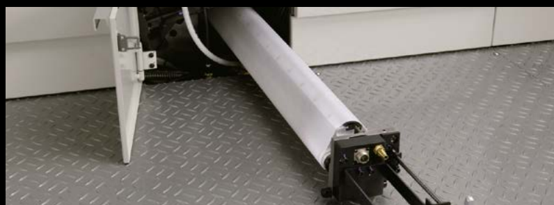
Автоматическая смывка офсетного и печатного цилиндров Программное управление делает автоматическую смывку эффективной и малоотходной, а смену полотна — простой и быстрой. Предварительно пропитанная ткань исключает распыление моющей жидкости и сокращает расход полотна.
