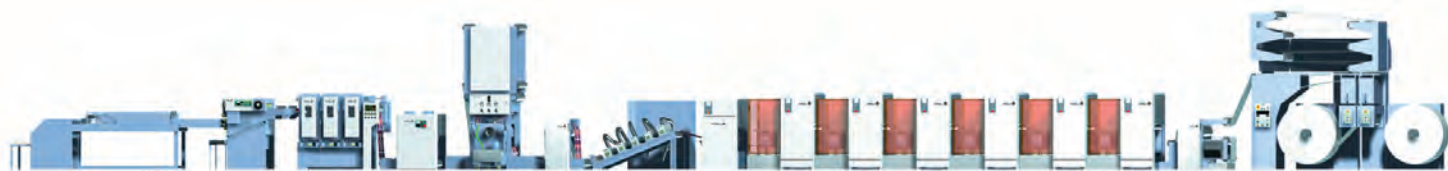
ЗАКАЗНАЯ РУЛОННАЯ МАШИНА С РОТАЦИОННОЙ ВЫСЕЧКОЙ И СЧЕТНО-КОМПЛЕКТУЮЩИМ УСТРОЙСТВОМ
