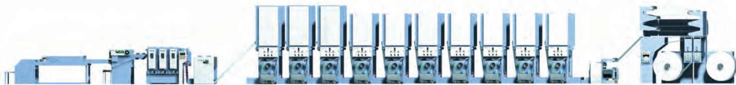
10-КРАСОЧНАЯ РУЛОННАЯ МАШИНА ГЛУБОКОЙ ПЕЧАТИ С РОТАЦИОННОЙ ВЫСЕЧКОЙ И СЧЕТНО-КОМПЛЕКТУЮЩИМ УСТРОЙСТВОМ
