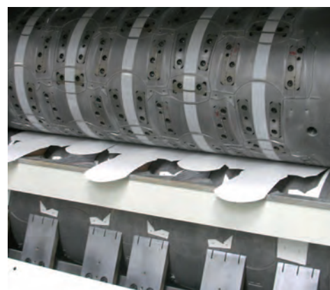
СЕКМЕНТНЫЙ ТИП ВЫСЕКАЛЬНОГО СО ВСТРОЕННЫМ УДАЛЕНИЕМ ОБЛОЯ
