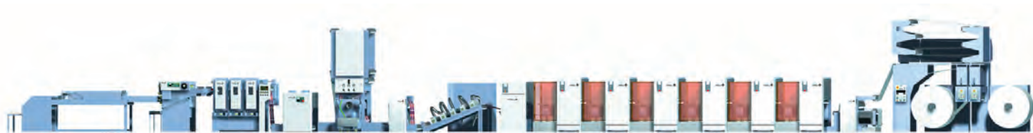
ЗАКАЗНАЯ РУЛОННАЯ МАШИНА С РОТАЦИОННОЙ ВЫСЕЧКОЙ И ПРИЕМНО-КОМПЛЕКТУЮЩИМ УСТРОЙСТВОМ
