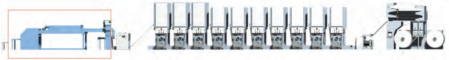
РУЛОННАЯ МАШИНА ГЛУБОКОЙ ПЕЧАТИ СО СЧЕТНО-КОМПЛЕКТУЮЩИМ УСТРОЙСТВОМ
