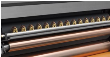
Автоматическая смывка красочных валков *
